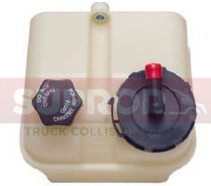
DEPÓSITO DIRECCIÓN HIDRÁULICA
